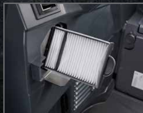
Filtre à air extérieur de climatisation
