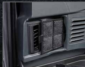
Filtre à air intérieur de climatisation
