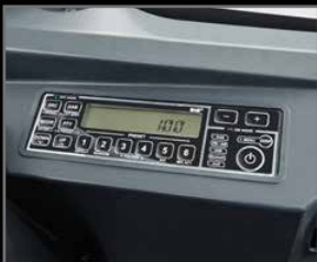
DAB+ Radio (FM/AM&AUX&Bluetooth® & Telefon-Freisprecheinrichtung)
