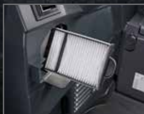
Filtro del climatizzatore per l'aspirazione dell'aria esterna
