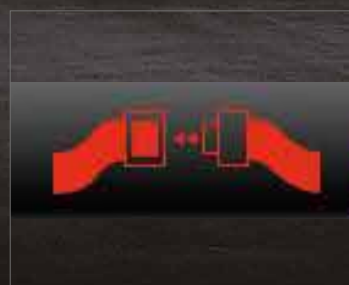
Indicador de cinturón de seguridad desabrochado en el monitor
