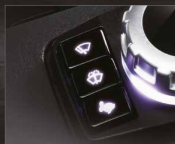
Función de ajuste de los limpiaparabrisas
