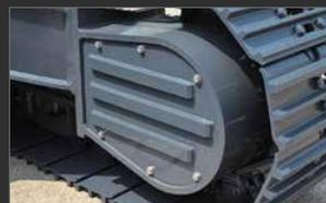
**Cubierta del motor de traslación reforzada**
