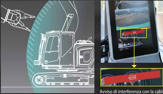
Avviso di interferenza con la cabina
