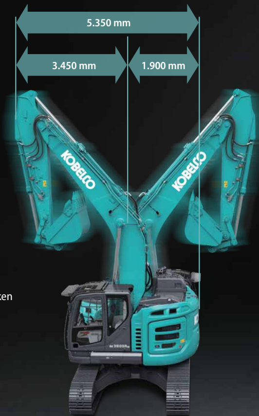
Getallen geven de specificaties aan voor een machine met standaard giek en standaard graafarm
