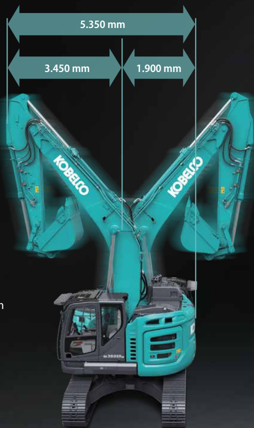
Getallen geven de specificaties aan voor een machine met standaard giek en standaard graafarm
