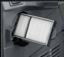
Frischlufffilter der Kabine
