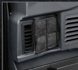
Umluftfilter der Kabine
