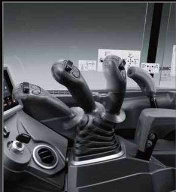
El operador puede desplazar las palancas horizontalmente sin torcer la muñeca, lo que reduce la fatiga provocada por el accionamiento.
