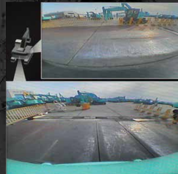
Caméras de droite/arrière en vision rectiligne
