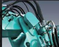
Capteur d'angle de la flèche intermédiaire
