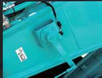
Capteur d'angle de la flèche principale
