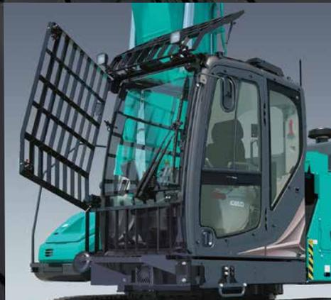
Vitres frontales et supérieure faciles à nettoyer grâce au système d'ouverture des grilles sans outil et à la passerelle avant.
