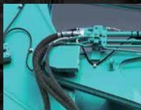
Capteur d'angle du balancier
