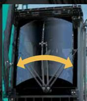
36 % größere Wischfläche des Frontwischers (im Vergleich zur Standardkabine)
