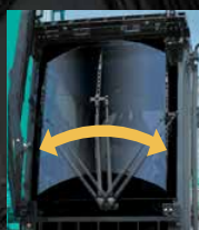
Area di spazzolamento del tergicristallo anteriore del 36% più ampia (rispetto alla cabina standard)
