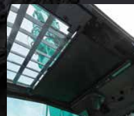
Parasole verticali ad apertura/chiusura scorrevole per bloccare la luce solare diretta
