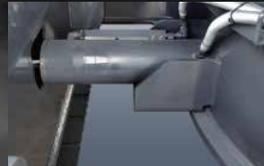
**Mecanismo de extensión/retracción de las orugas (solo SK400DLC)**
