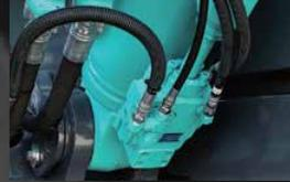
**Válvula de seguridad del balancín, el brazo y el cilindro del aguilón**
