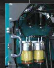
**Vorfilter mit integriertem Wasserabscheider**
