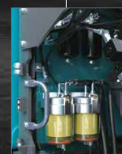
Voorfilter met ingebouwde waterafscheider
