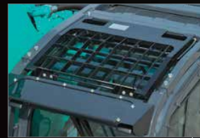
Protector superior del conductor de nivel II estándar La protección superior estándar de la cabina se puede abrir para facilitar la limpieza de las ventanas.
