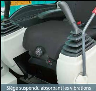
Siège suspendu absorbant les vibrations
