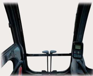
Le champ de vision est conforme et au-delà aux normes ISO, la vision périphérique réduit au minimum les angles morts.
