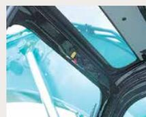
Le pare-brise s'ouvre et se ferme d'une seule pression grâce au dispositif de déverrouillage
