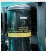
Les filtres à hautes performances et grande capacité sont conçus spécifiquement pour le moteur à injection à rampe commune.
