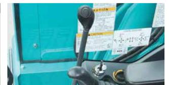
Commutateur additionnel de sélection de la vitesse de translation sur le levier de commande de la lame
