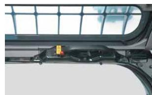
La pare-brise s'ouvre et se ferme d'une seule pression grâce au dispositif de déverrouillage
