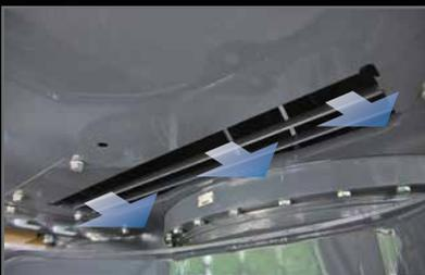
Les gaz d'échappement sont ralentis et dispersés dans le flux de ventilation sous la tourelle par les chicane d'insonorisation.
