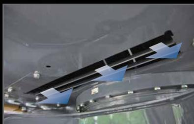
Il condotto disassato rallenta i fumi di scarico dalla marmitta e la ventola di raffreddamento del motore.
