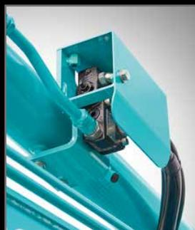
Valvola di sicurezza per il cilindro del braccio di scavo
