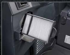
Filtro del climatizzatore per l'aspirazione dell'aria esterna
