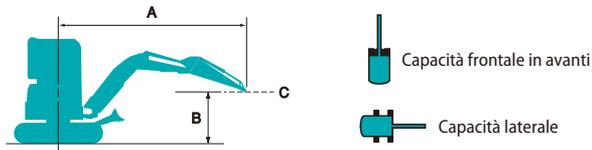
A: Raggio dall'asse di rotazione alla parte superiore del braccio di scavo
