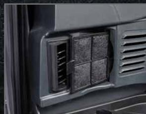
Filtro del climatizzatore per la circolazione dell'aria interna
