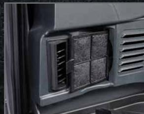
Filtro del aire acondicionado para la circulación del aire interior
