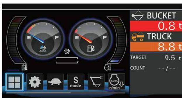
Une alarme sonore et un affichage spécifique sur le moniteur informe le chauffeur du niveau de charge par rapport à la capacité du camion.
