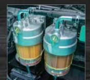
**Préfiltres à carburant avec décanteur d'eau**
