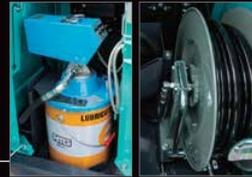
**Enrouleur automatique du flexible de graissage**
