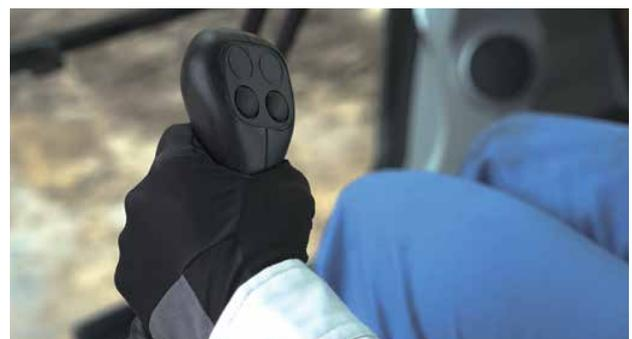
Die Materialverwiegung wird mit dem Griffschalter gestartet / gestoppt, sodass der Fahrer die Verwiegung durchführen kann, ohne den Hebel loszulassen.
