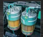
**Vorfilter mit integriertem Wasserabscheider**
