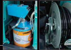
Fettpressenhalter mit autom. Aufwicklung Schmiermittelbehälter/Abschmierschlauch
