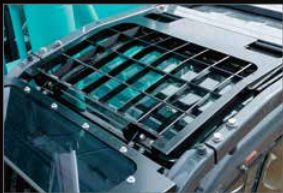
FOPS-Kabinenschutz-aufbau als Standard
