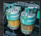
Vorfilter mit integriertem Wasserabscheider
