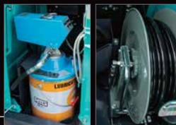
**Supporto per l'ingrassatore a siringa con bobina automatica**
