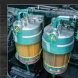
Voorfilter met ingebouwde waterafscheider
