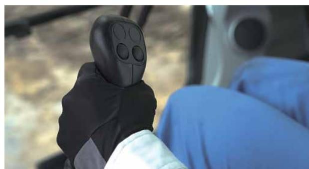
El proceso de pesaje se inicia/detiene con el interruptor de la empuñadura, lo que permite al operador realizar el pesaje sin soltar la palanca.
