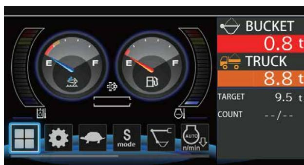
Incluye una función de alarma para prevenir cargas excesivas e insuficientes. Avisa al operador mediante un zumbador y una pantalla emergente en el monitor.
