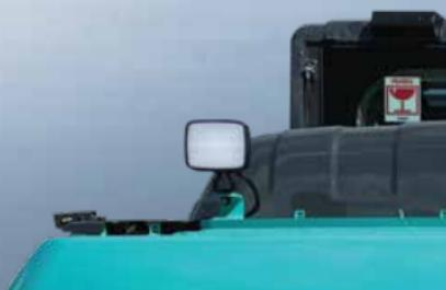
A partir de los modelos -11E se han añadido dos luces led adicionales en la parte superior del contrapeso para tener mayor seguridad.
