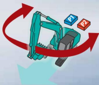
La Traslación Independiente Automática dedica una bomba hidráulica a la traslación y otra al implemento de forma continua, permitiendo una velocidad de desplazamiento suave y constante incluso al rotar o usar el balancín o el implemento. Con Traslación Independiente, la seguridad transportando un gran tubo por una obra es coser y cantar.
