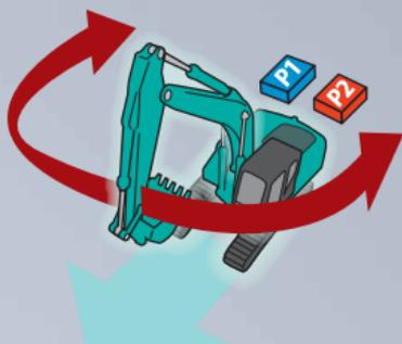
Si se selecciona la Traslación Independiente se dedica una bomba hidráulica a la traslación y otra al implemento de forma continua, permitiendo una velocidad de desplazamiento suave y constante incluso al rotar o usar el balancín o el implemento. Con Traslación Independiente, la seguridad transportando un gran tubo por una obra es coser y cantar.
