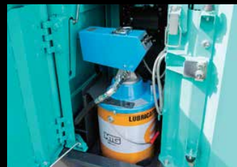
Pompe de graissage électrique Graissage rapide et facile des axes.
