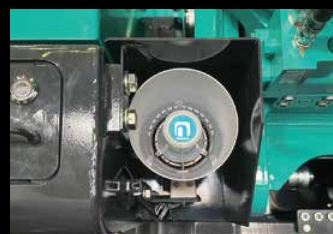
Mégaphone extérieur Le chauffeur peut alerter ses collègues au sol sans quitter les commandes de la machine.
