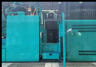
2 Passerelle de maintenance Une large passerelle sécurisée facilite l'accès aux points de contrôle et d'entretien en milieu de tourelle.
