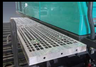
Passerelles amovibles Des passerelles sont prévues sur les côtés gauche et droit de la tourelle, pour sécuriser l'accès à l'entretien.
