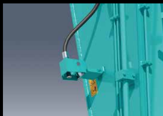
2 buses de pulvérisation d'eau Les balanciers sont équipés de deux buses de pulvérisation d'eau pour abattre les poussières.
