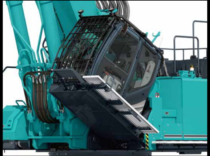
La cabine est inclinable jusqu'à 30°
