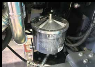
Filtration des lignes de drain Exclusif à Kobelco, et pour une fiabilité sans faille, les circuits hydrauliques de retour de fuite sont filtrés efficacement.
