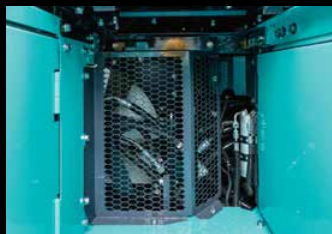
Ventilateurs réversibles Le système de refroidissement est protégé des poussières par des ventilateurs réversibles automatiques.
