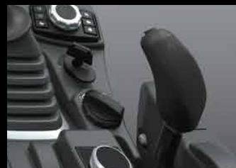
Commande de la 2 ème articulation Commande dédiée à la deuxième articulation de l'équipement grande hauteur à 4 éléments.
