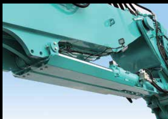
Protection des vérins de flèche articulée Protection des 2 vérins de l'articulation de flèche de l'équipement court de démolition.
