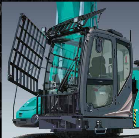
Protection de cabine ouvrable pour nettoyer les vitres
