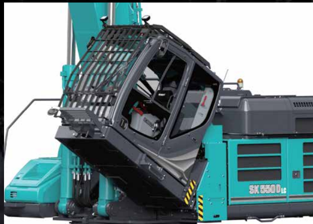
La cabine est inclinable jusqu'à 30°
