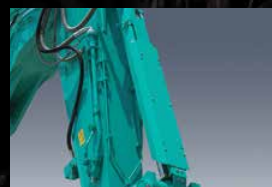
Schutz des Löffelzylinders Verhindert, dass der Zylinder durch herabfallenden Schutt beschädigt wird.
