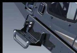
Tritstufe zur Kabine Für bequemen Zugang zur gekippten Kabine.
