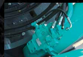
Sicherheitsventil für Ausleger- und Stielzylinder Verhindert, dass das Anbaugerät absinkt, falls ein Schlauch beschädigt wird.
