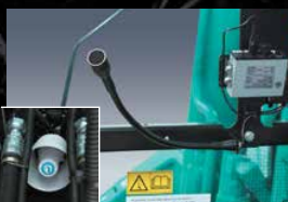
Lautsprecheranlage für Durchsagen Alarmieren der Mitarbeiter in der Umgebung mit klarer Audioqualität.
