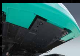
Verstärkte Schutzabdeckungen unter dem Oberwagen Die 6 mm dicke Stahlplatte schützt die Bauteile im Bagger.
