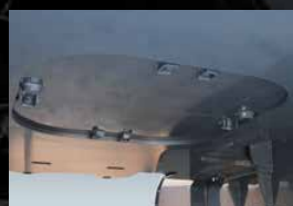
Unterwagen-Schutz Die 9 mm dicke Stahlplatte schützt die Hydraulikkreise des Fahrsystems.
