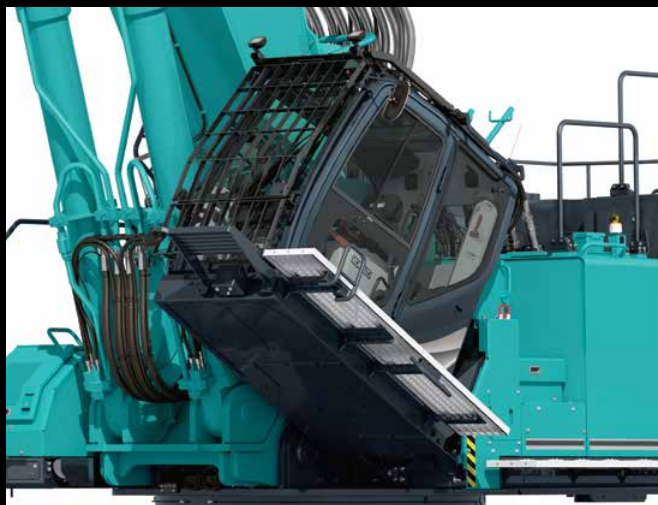
La cabina può essere inclinata fino a 30°
