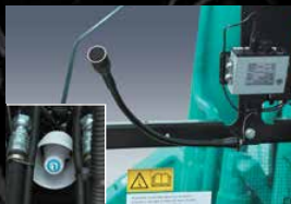
Sistema d'indirizzamento pubblico Avvisa tutti i lavoratori nell'area con una qualità audio ottimale.
