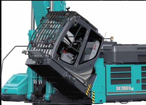
La cabina può essere inclinata fino a 30°
