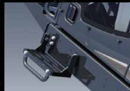
Gradino per l'accesso in cabina Posizionato per offrire un comodo accesso alla cabina inclinata.
