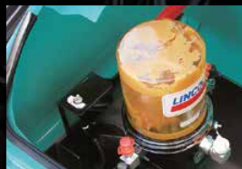
Sistema di lubrificazione automatica Per lubrificare rapidamente gli accessori.
