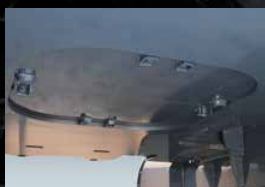
Protezione del telaio inferiore Una copertura in lamiera d'acciaio da 9mm di spessore protegge i circuiti del sistema di traslazione.
