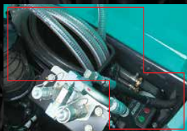
Pompa di rifornimento Per un rifornimento di carburante rapido e sicuro da terra.
