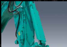
Protezione del cilindro della benna Previene i danni al cilindro a causa della caduta di detriti.
