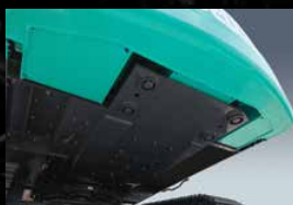
Telaio superiore rinforzato sotto le coperture di protezione Le coperture in lamiera d'acciaio da 6mm di spessore proteggono i dispositivi presenti nella macchina base.
