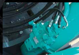
Valvola di sicurezza per il cilindro del braccio di sollevamento, del braccio di scavo e del bilanciante Previene la caduta dell'accessorio in caso di rottura delle tubazioni.
