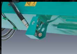
Spruzzo d'acqua È disponibile un circuito di scarico per evitare la formazione di ruggine.
