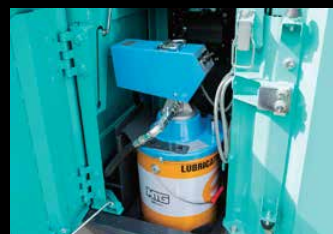
Elektrisch smeersysteem Het smeren van elke pen in de bewegende delen van het hulpstuk kan snel en met minimale inspanning worden uitgevoerd.
