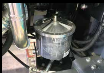
Aftapfilter Voor het eerst in deze klasse is de machine voorzien van een hydrauliekaftapfilter voor een betere filtratie en betrouwbaarheid.
