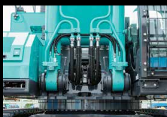
Veiligheidsklep Giek-, arm- en stecilinders zijn uitgerust met veiligheidskleppen voor meer veiligheid.
