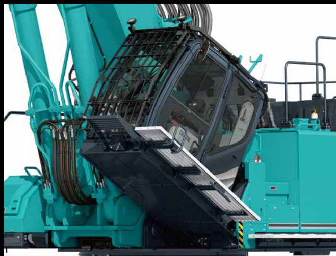
La cabina se puede inclinar hasta 30°.
